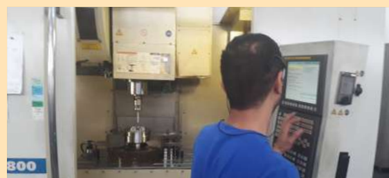
Figura 5. Usinagem em CNC do bloco de conexão do SMT-20
