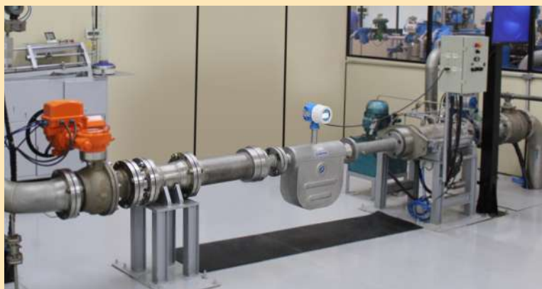
Figuras 6 e 7. Calibração do Medidor Axiom MMF-80 no laboratório de Vazão Metroval, que atende a todos os requisitos da norma NBR-ISO/IEC 17025.
